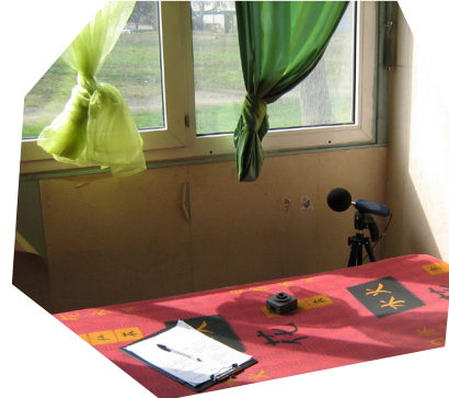
Mesure du bruit des aéronefs dans la chambre à coucher d'un riverain dans le cadre de l'étude pilote du programme de recherche DEBATS
